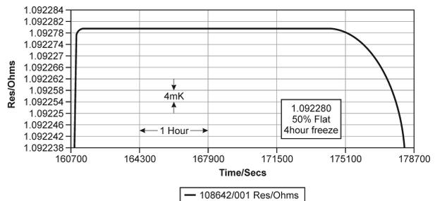
**FIGURE 9.** Copper IsoTower Freeze Plateau – 02-25-2010
