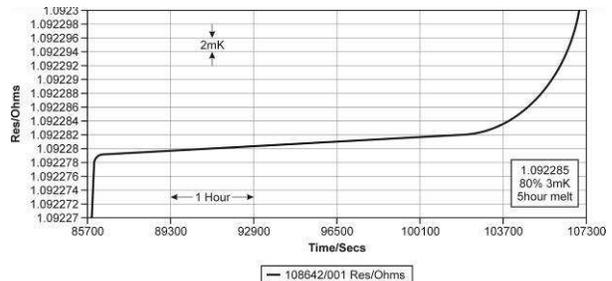
**FIGURE 8.** Copper IsoTower Melt Plateau – 02-24-2010
