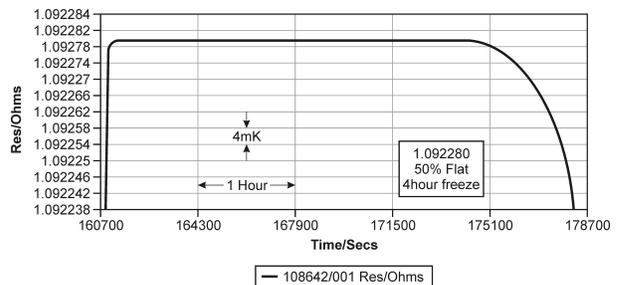
**FIGURE 9.** Copper IsoTower Freeze Plateau – 02-25-2010
