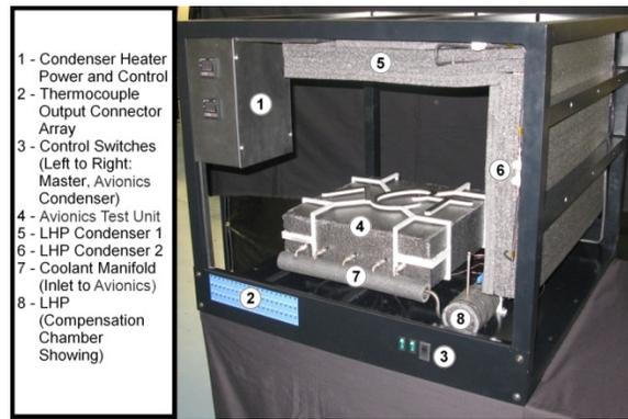
**Figure 21. Avionics Thermal Management Test Unit**
